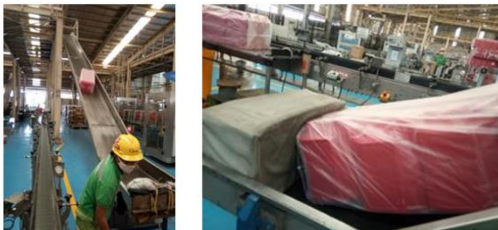
Gambar 4. Bantalan Karet Pada Sliding Filling Lithos .
