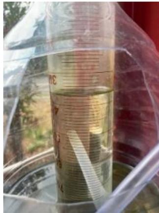
**Gambar 2** Pengukuran Gas Menggunakan Gelas Ukur
